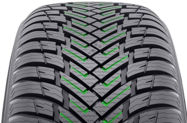
Tiefe und offene Kanäle auf den Blöcken in der Mitte (Zentrale Blockrinnen) erhöhen den Griff unter extremen Bedingungen. Die Kanäle arbeiten auch mit voller Kraft bei Nässe. Sie schieben wirkungsvoll Schneematsch und Wasser zwischen Reifen und Strasse weg, was Schneematsch-Aquaplaning und Aquaplaning verhindert. Die exzellenten Aquaplaning-Eigenschaften werden durch die polierten Rillen optimiert, die das Entfernen von Wasser und Schneematsch beschleunigen.
